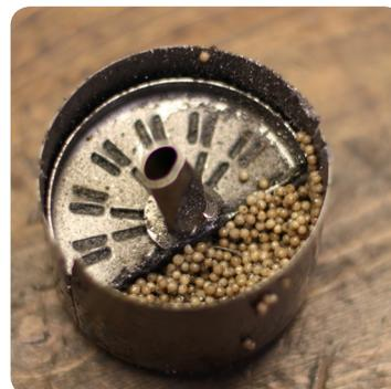
Eingeweichte und zu ölige Trockenmittelschichten im Inneren des Sammlertrockners
