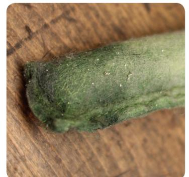
Abgenutzte Einlagebeutel des Trockners - Trockenmittel, durchweicht aufgrund zu viel hinzugefügtem UV-Mittel in das System
