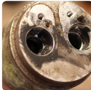
Eine solche Kontamination der Ein- und Ausgänge entspricht einer Verstopfung des Trockners
