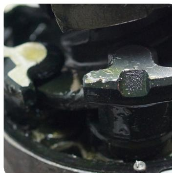
Kristallisiertes Leckstopfmittel verdickte das Öl und erzeugte sichtbaren Schleim auf Taumelscheibe und Kolben
