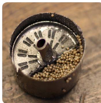
Gennemblødt og for oliefedtet tørremiddellag inden i filteret
